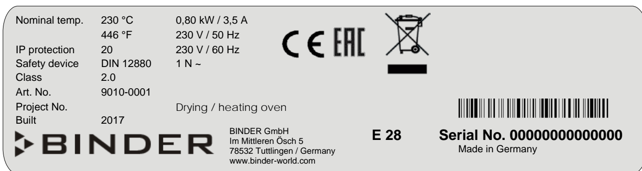
Abbildung 2: Typenschild (Beispiel E 28 Standardgerät)
